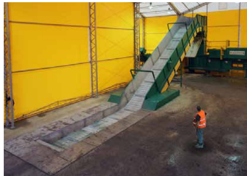
SEÇÃO DE CARREGAMENTO NO POÇO
