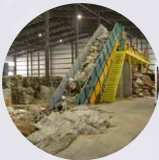
CINTAS DE CARGA A LA PLATAFORMA
