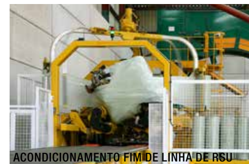
ÁREA DE RECEÇÃO DE FIM DE LINHA E ENFARDAMENTO DE MATERIAL RECICLÁVEL E RSU
