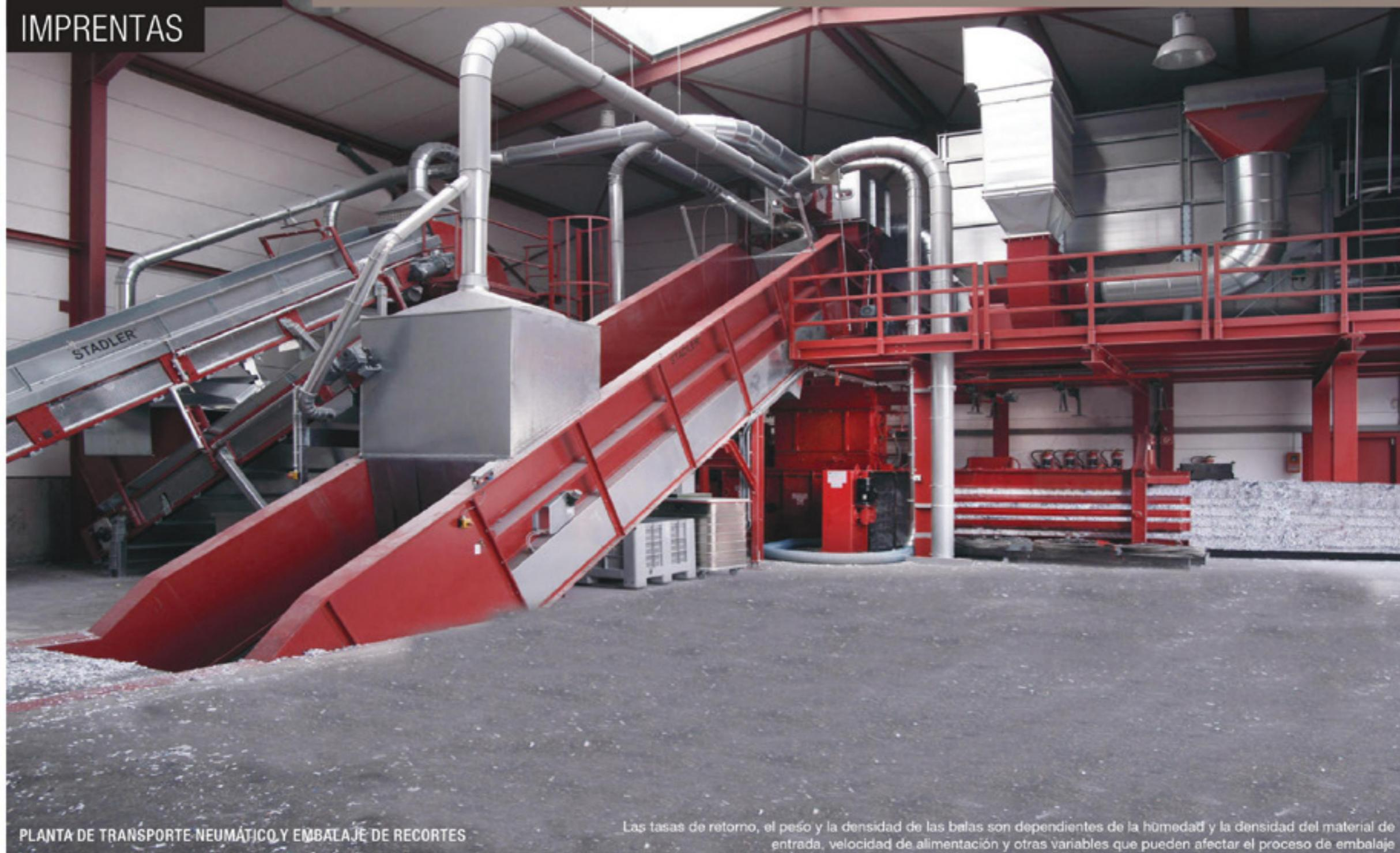
PLANTA DE TRANSPORTE NEUMÁTICO Y EMBALAJE DE RECORTES
