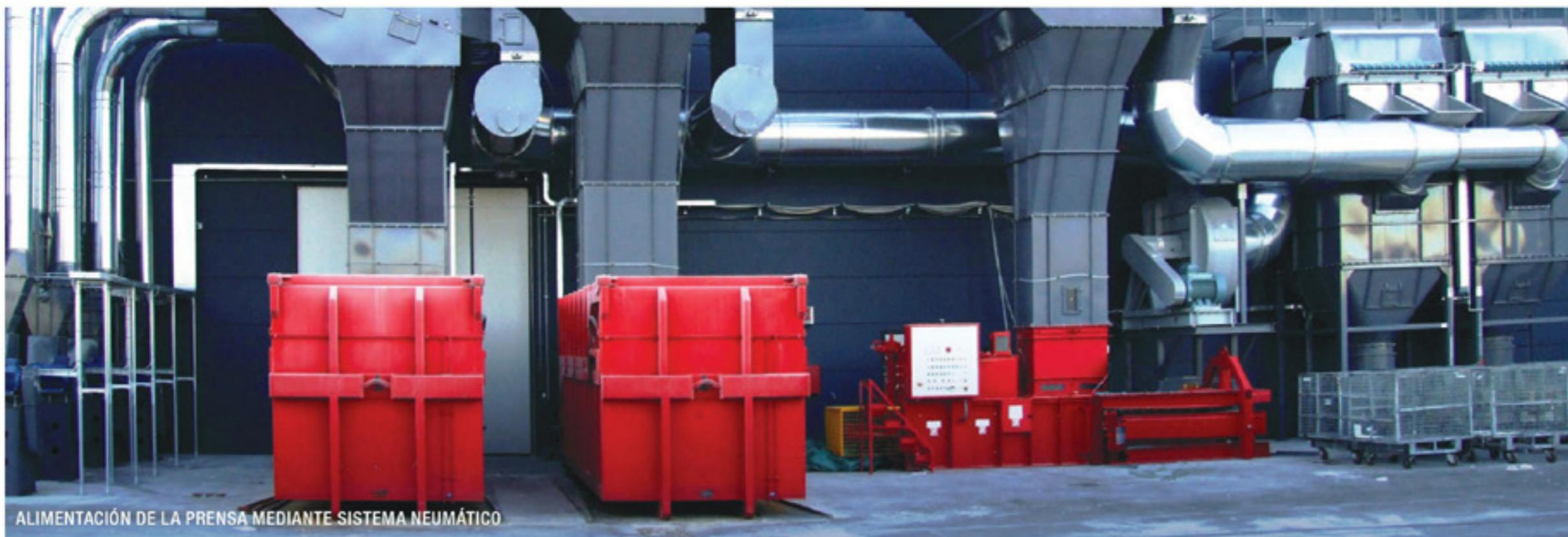
ALIMENTACIÓN DE LA PRENSA MEDIANTE SISTEMA NEUMÁTICO
