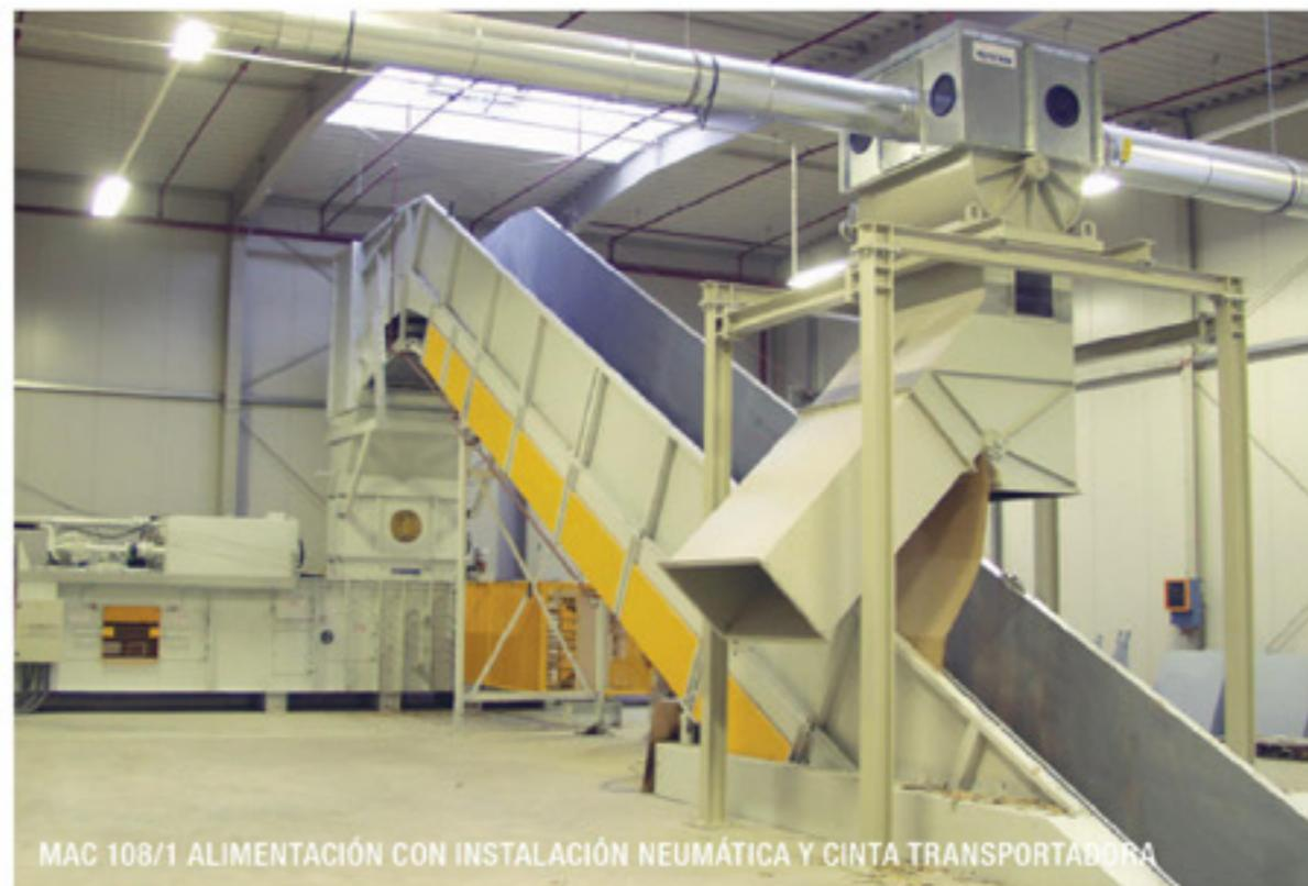
MAC 108/1 ALIMENTACIÓN CON INSTALACIÓN NEUMÁTICA Y CINTA TRANSPORTADORA
