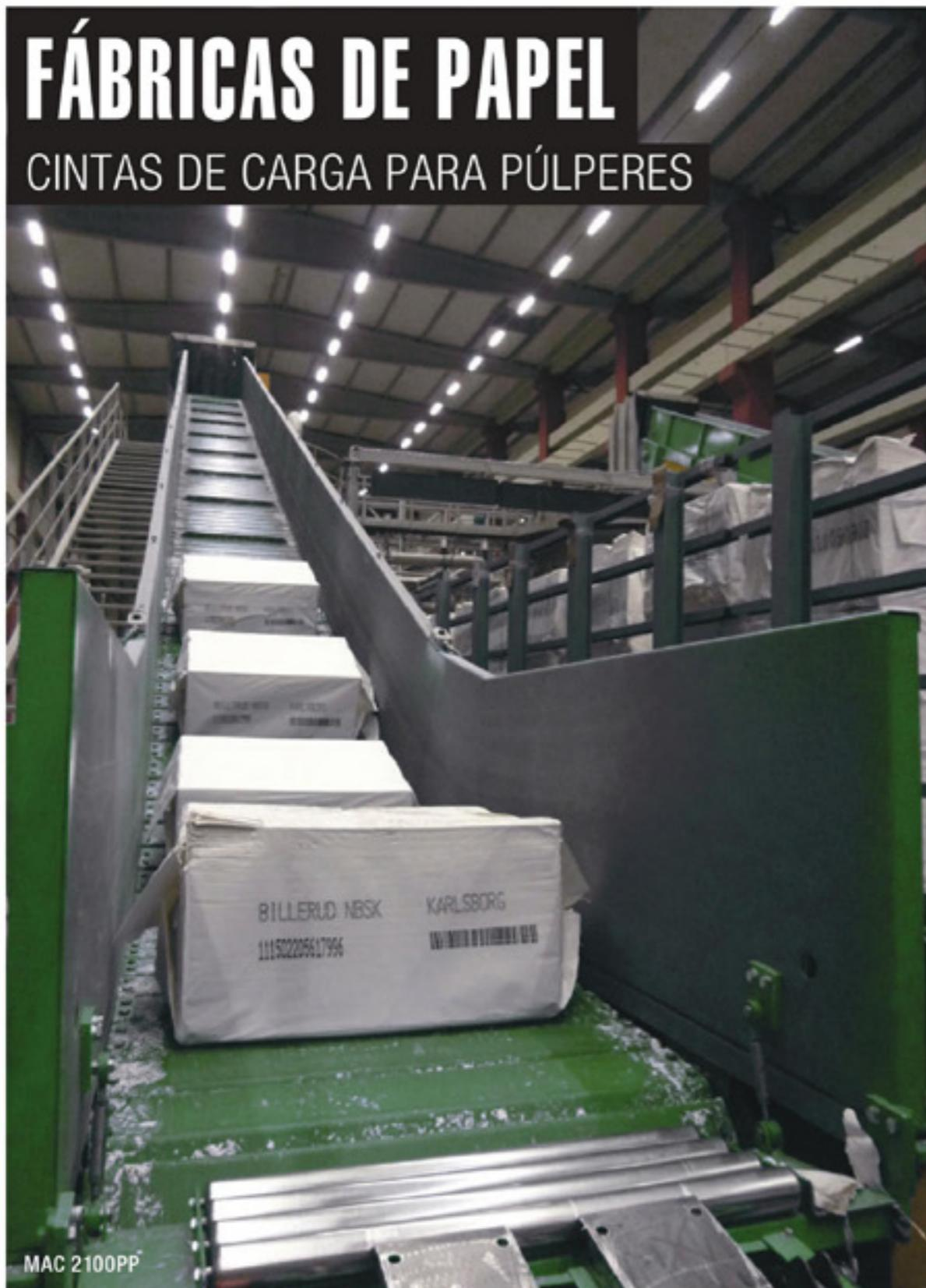
ESTÁN DISEÑADAS PARA ALIMENTAR PÚLPERES DE PAPEL; PUESTO QUE LAS BALAS Y LOS PAQUETES DE CELULOSA TIENEN UN ALTO PESO ESPECÍFICO, LA ROBUSTEZ Y LA RESISTENCIA AL DESGATE SON CARACTERÍSTICAS FUNDAMENTALES.
