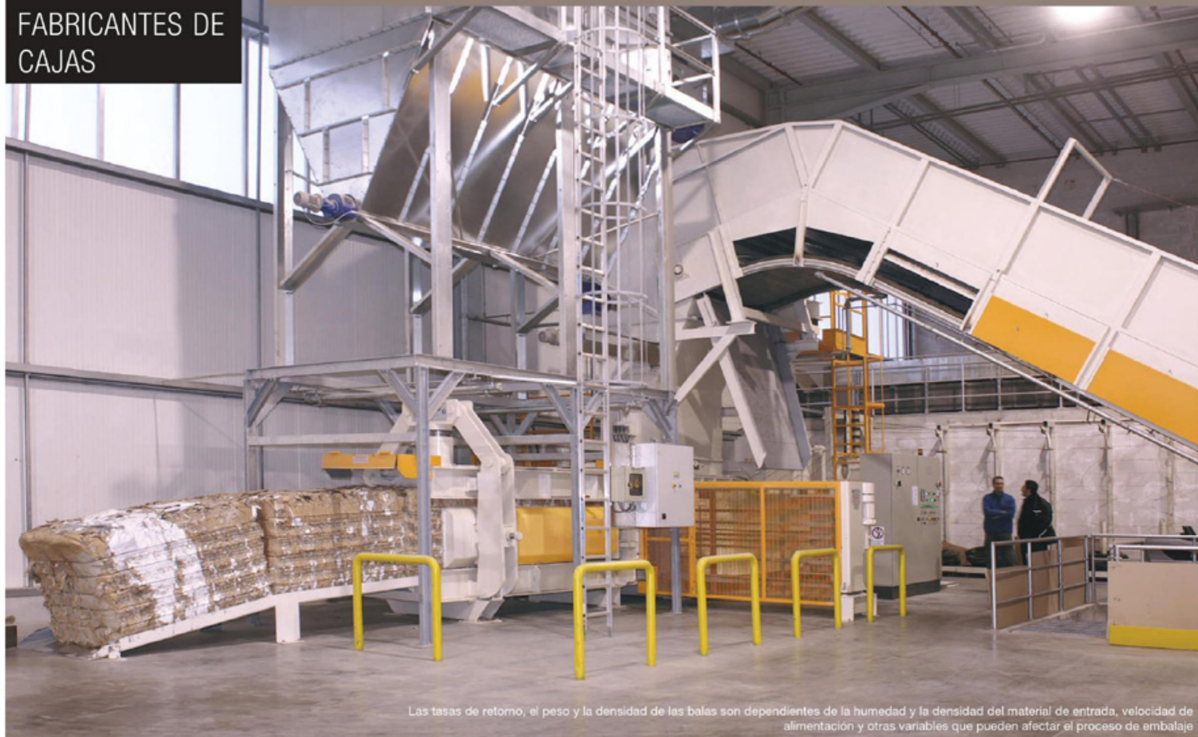
Las tasas de retorno, el peso y la densidad de las balas son dependientes de la humedad y la densidad del material de entrada, velocidad de alimentación y otras variables que pueden afectar el proceso de embalaje
