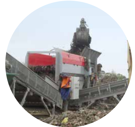
BELADEN DER DYNAMISCHEN SIEBANLAGE
