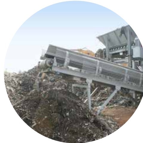
INERTMATERIAL AUS DEM UNTERSIEB
